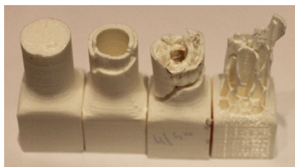
Рис. 12. Примеры разрушения элементов из PLA пластика
