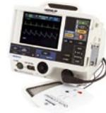
использоваться во время транспортировки. Прибор оснащен бифазной технологией с возможностью увеличения энергии разряда до 360 Дж.
