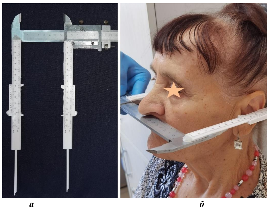
Рисунок 2 – Модифицированный штангенциркуль для измерения ширины и глубины лица (а) и методика измерения (б)
