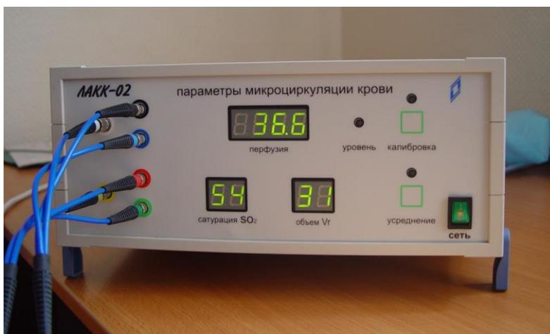
Фото 46. «ЛАКК-02» - лазерный анализатор микроциркуляции крови производства НПП «Лазма»
